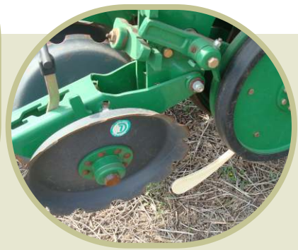
Saaddruksisteem met die drukvinger
