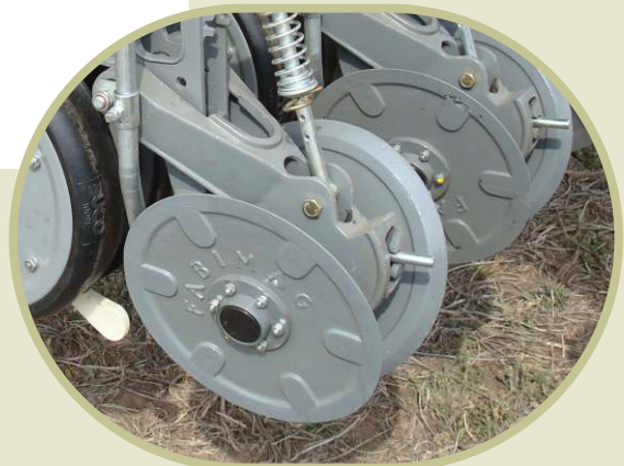
Rigiede metaalwiele word aanbeveel vir los- en sandgrond
