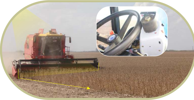
Stroper wat bestuur word deur outomatiese stuur met die tafel wat gebruik word volgens die volle werkswydte
