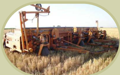
Uitmekaargehaalde planteenheid waarvan een van die dieptebeheerwiele afgehaal is asook een van die voorloopmakers. Regs-onder: Vertikale snit van die werk van 'n geenbewerkingsplanter met turbo kartelkouter, die ligging van die saad en die toemaak van die voor.
