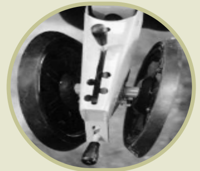
Die rubberwiele met trapesiumvormige kante is meer geskik vir nat- en swaargronde.
