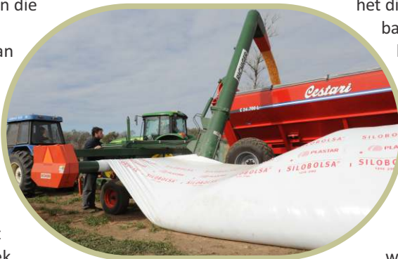
Silosak-uitapper en tapkar wat die graan ontvang.
