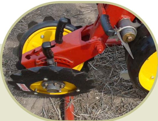
Wiele met getande bybehore aan die binnekant van die wiel en met die konkawiteit na buite, minder aggressief
