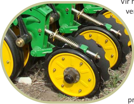
Wiele met getande bybehore aan die buitekant van die wiel en met die konkawiteit na binne, meer aggressief
