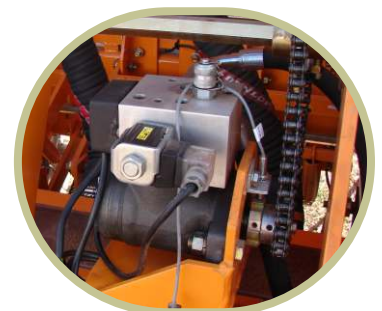
Hidroliese sisteem vir veranderliedosis toediening
