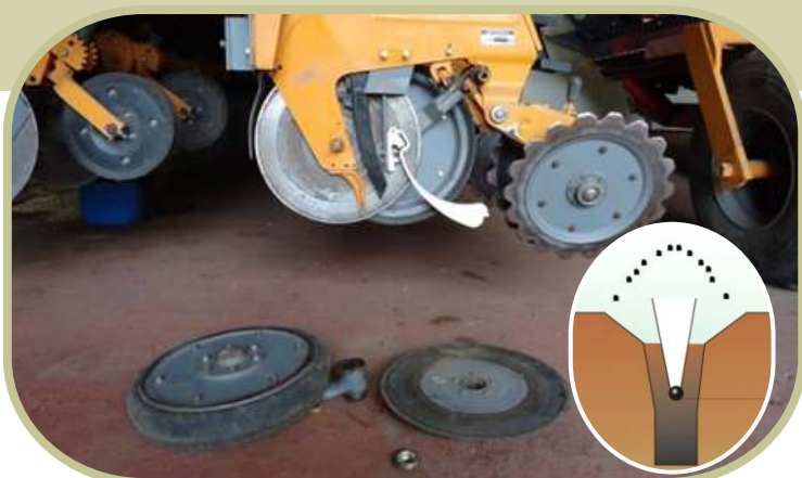
Uitmekaargehaalde planteenheid waarvan een van die dieptebeheerwiele afgehaal is asook een van die voorloopmakers. Regs-onder: Vertikale snit van die werk van 'n geenbewerkingsplanter met turbo kartelkouter, die ligging van die saad en die toemaak van die voor.
